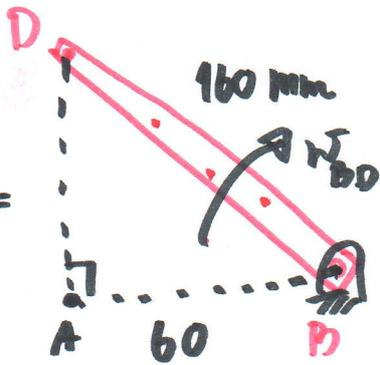
$$\vec{v}_D = [\vec{v}_D]_{\text{Translation mit B}} + [\vec{v}_D]_{\text{Rotation about B}}$$
